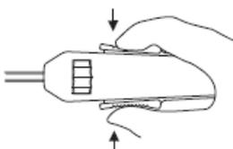
6. クリップを外す為にはレバーを離し、本体を組織から外して下さい。（閉鎖したクリップは自動的に本品のアゴから外れる）本品のアゴには、自動的に次のクリップが装填されます。
